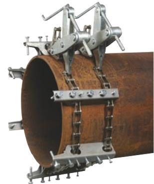
Das Doppelketten-Spannsystem Typ 2500D ist ein einfaches Werkzeug für das Spannen von Rohr-an-Rohr, Rohr-an-Rohrbogen, Rohr-an-T-Stück oder Rohr-an-Flansch. Das geringe Gewicht erlaubt ein einfaches Arbeiten in der Werkstatt oder auf der Baustelle. Dieses Spannsystem ist auch für Rohre mit Wandstärken bis zu 1/2" (12mm) geeignet und besitzt eine Spannkraft von 2500 kg.
