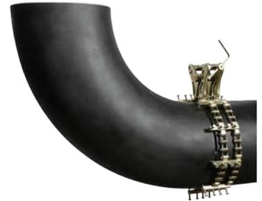
Mit den Kettenspannern S200 & D200 und DK200 können Rohre mit einer Wandstärke bis zu 12,7 mm gespannt werden. Um sie an die jeweilige Rohrdimension anzupassen, müssen die entsprechenden Kettenglieder und Hebel ausgetauscht werden.
