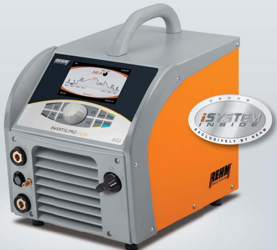
! Die Wartung von Schweißstromquellen muss laut BGV A 3 und VDE 0544-207 einmal im Jahr durchgeführt werden. Unsere Serviceabteilung hilft.
